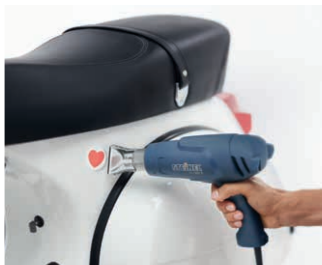
Отстраняване. С помощта на горещ въздух лепенките се свалят по-лесно.
