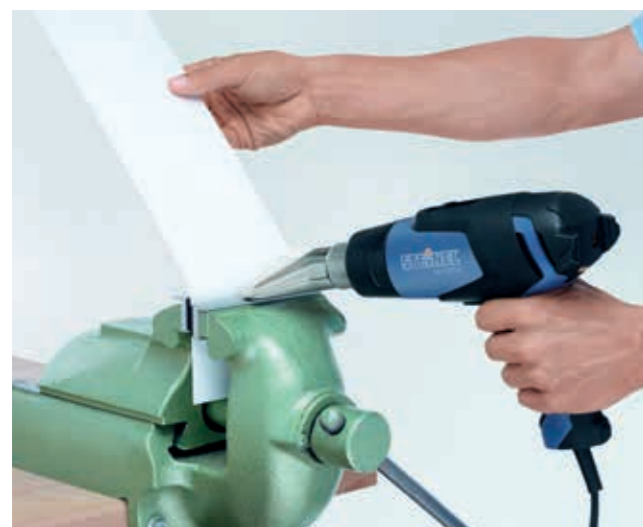
Деформиране. Придаване на желаната форма на пластмаса посредством топлина.
