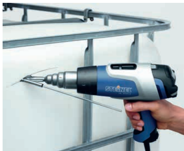
Поправка. Заваряване на воден контейнер от PVC.
